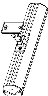
Colonna sonora 2 vie HF, di facile installazione, dotata di trasformatore interno, griglia metallica di protezione e corpo in Alluminio che conferisce all'apparecchio un'elevata robustezza meccanica. Particolarmente indicata in ambienti acusticamente critici, dove grazie alla particolare costruzione riesce a garantire un'elevata direttività del suono.
